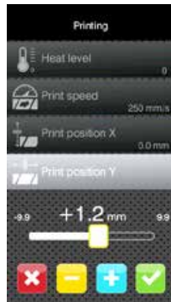
調整標籤列印定位 Y 使用滑桿快速調整， 使用 ± 按鍵精準調整
